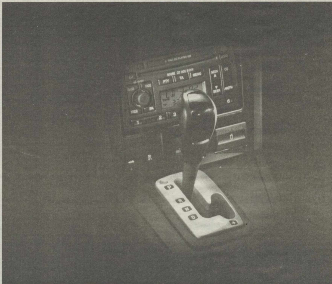
El Durashift 5-tronic es el primer cambio automático-secuencial desarrollado por Ford
