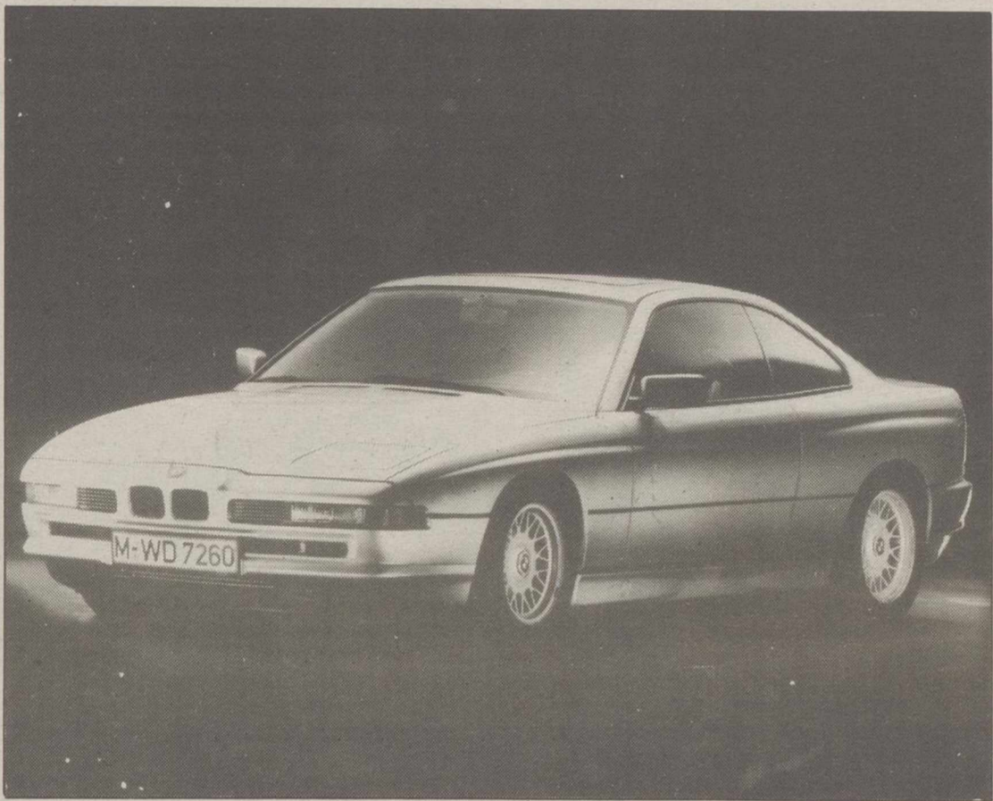
El 850i posee un motor de 12 cilindros en V con cinco litros de cilindrada.
