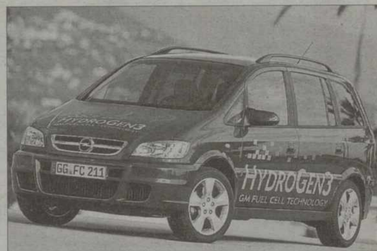
Modelo de Opel propulsado por motor de hidrógeno líquido.
