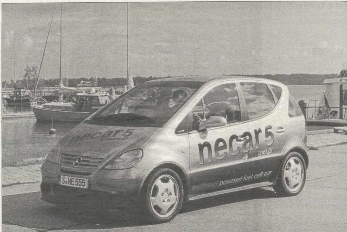
De aspecto exterior igual que cualquier Clase A, el misterio está debajo de los asientos, en un motor que quema hidrógeno
