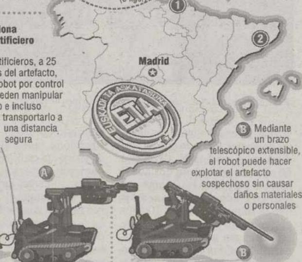
B Mediante un brazo telescópico extensible, el robot puede hacer explotar el artefacto sospechoso sin causar daños materiales o personales.
