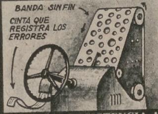
**3.ª y 4.ª RESISTENCIA A LA MONOTONIA Y HABILIDAD EN EL MANEJO DEL VOLANTE.**—Una banda sin fin, con perforaciones, pasa delante de un cursor. Este se mueve con el volante, para que no pase por un agujero y haga contacto, registrando la falta eléctricamente. Se repite cinco veces.
