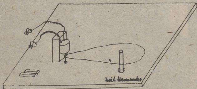
cócala la pila entre las dos maderitas que estan pegadas en la tabla y mete una madera que tiene un "motor" y dos hilos de colores en el agujero que tiene la tabla
