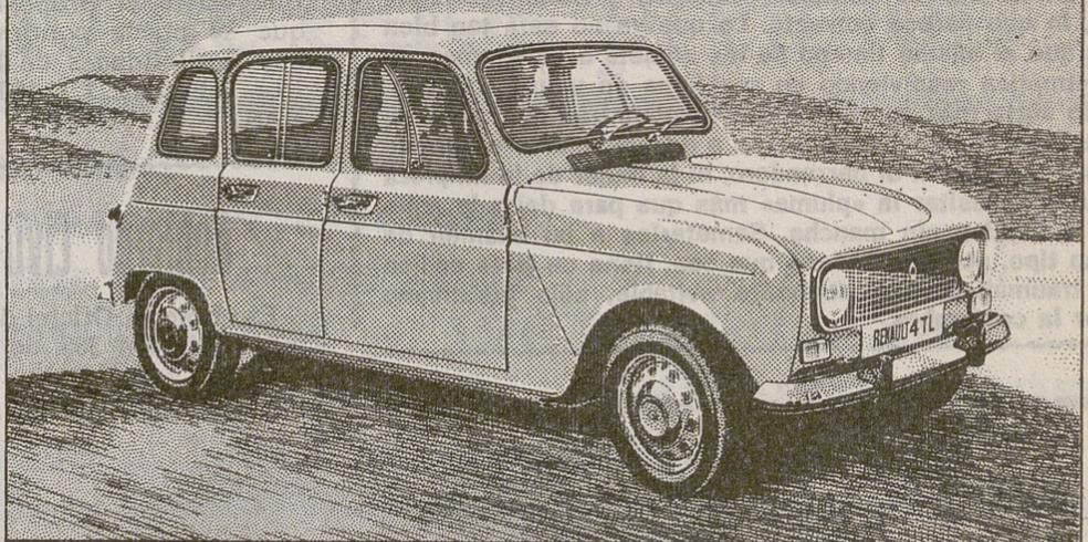
Si usted tuviera un Renault 4, todos los caminos serían buenos: llevaría una suspensión por barras de torsión independiente a las cuatro ruedas e iría con el suelo del coche a 18 centímetros del terreno. Y llevaría hasta 1.185 dm<sup>3</sup> de equipaje al fin del mundo gracias a su robusto motor de 852 cm<sup>3</sup> y tracción delantera.
