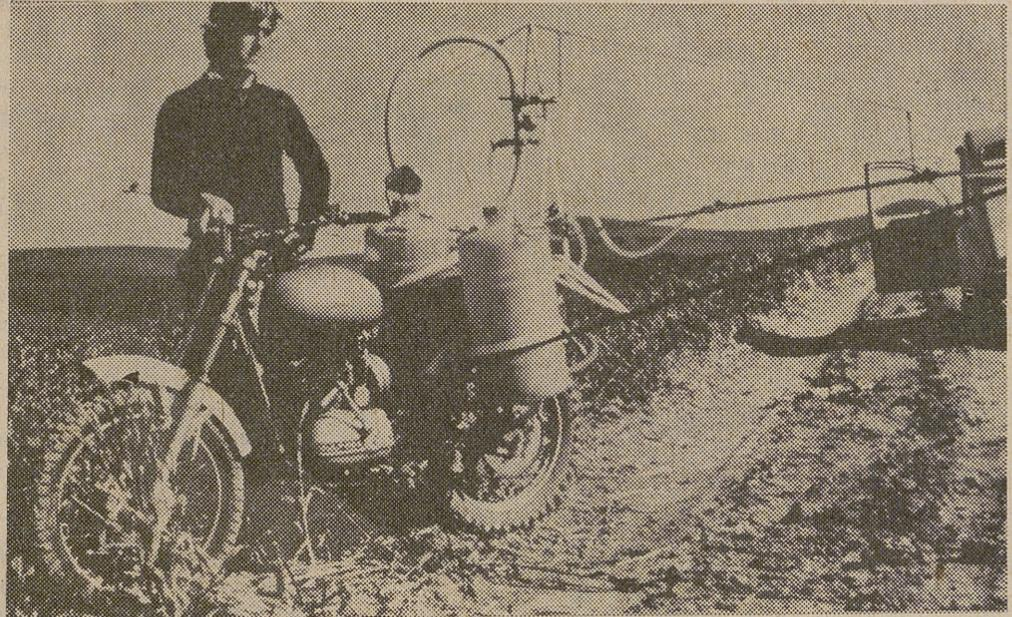
Tres hermanos de Marchena (Sevilla), han ideado un sistema que sustituye ventajosamente al tractor en los trabajos de reparto de herbicidas e insecticidas. Se trata de un bastidor acoplable a una motocicleta. Mientras las ruedas del tractor aplastan y destruyen muchas plantas sembradas, la moto puede circular por la parte baja de los surcos.—(FOTO EFE - FIEL)
