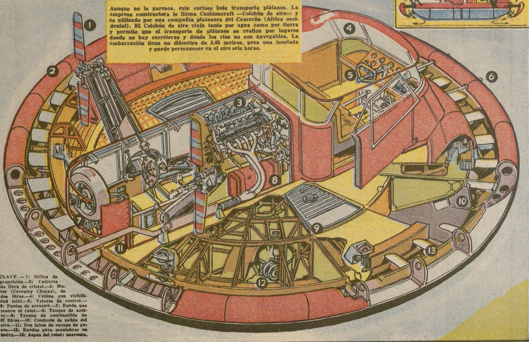
CLAVE. — 1: Hélice de propulsión.—2: Cubierta de fibra de cristal.—3: Motor (Coventry Climax), de dos litros.—4: Cabina con visibilidad total.—5: Volante de control.—6: Punto de arrastre.—7: Rueda que mueve el rotor.—8: Tanque de aceite.—9: Tanque de combustible de 87 litros.—10: Conducto de salida del aire.—11: Dos tubos de escape de rueda.—12: Ruedas para maniobrar en tierra.—13: Aspas del rotor: SHAFTS.
