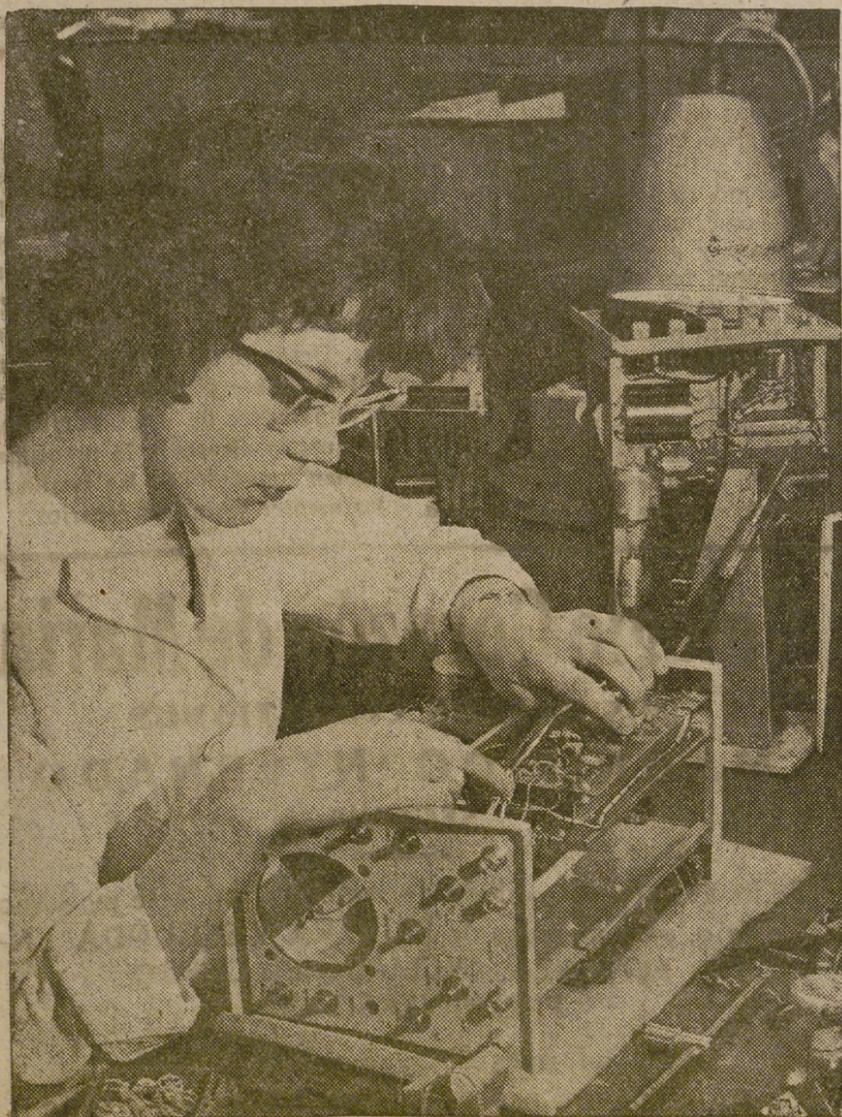
Montaje de un osciloscopio portátil, para el ensayo de circuitos de radio y electrónicos.
