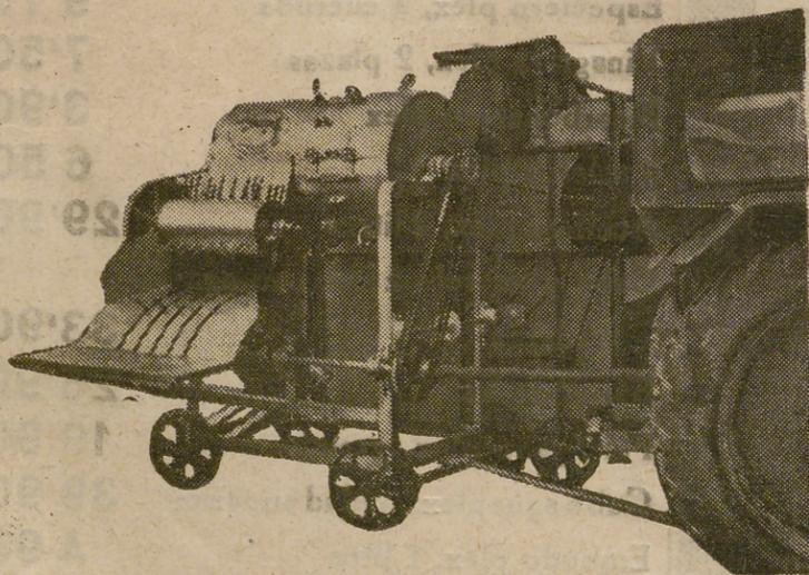
Cuerpo de Trilla «LAGARTO» acoplado a Ensacadoras. Con un solo motor se accionan las dos máquinas a la vez. También puede accionarse por Tractores mediante CARDAN
