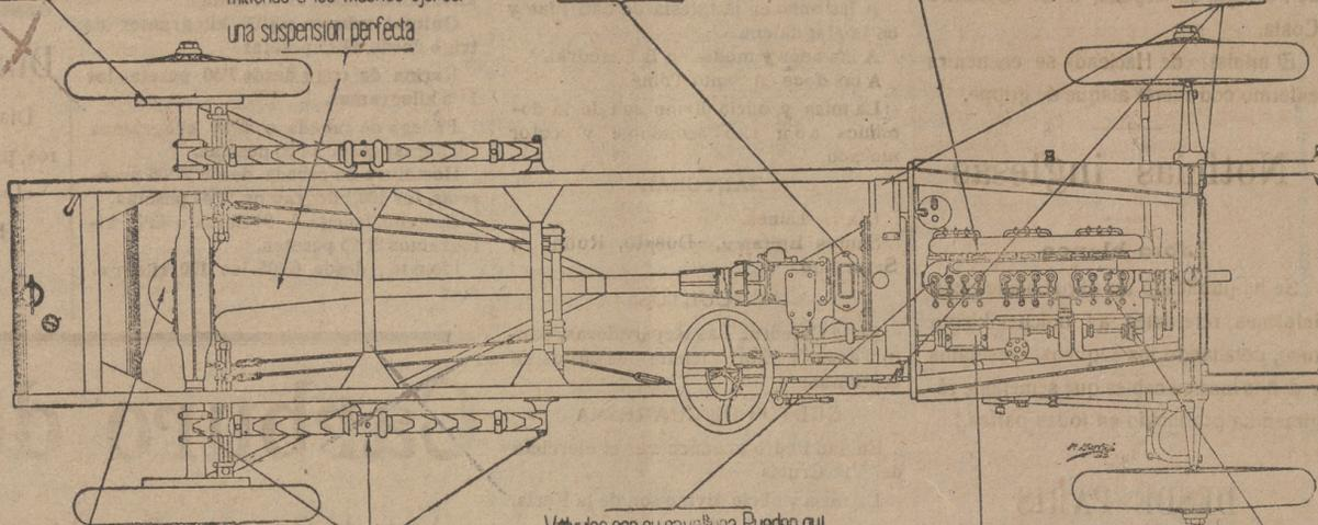
Corona y piñon del diferencial con engranajes helicoidales suprimiendo el ruido que producen los engranajes rectos.
