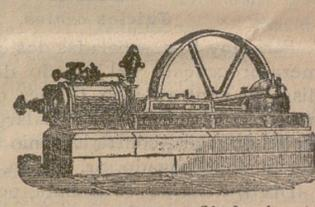
Máquina de vapor fija horizontal
