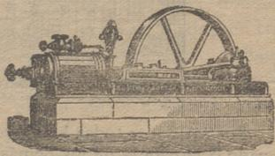
Máquina de vapor fija horizontal
