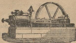
Máquina de vapor fija horizontal.
