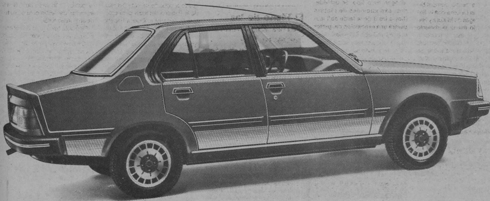
Con el Renault 18 GTX y su motor de 2 litros, el Estilo adquiere una nueva y especial dimensión: La confianza de poder superarlo todo. Motor de 1.995 cm<sup>3</sup>, 102 CV y 181 Km/h. de velocidad máxima.
