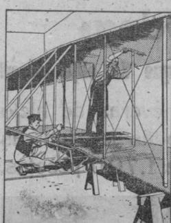
**AEROPLANO.**—En el mes de septiembre de 1903, los hermanos Wright terminaron la construcción de su primer aeroplano. Se trataba de un biplano con una envergadura de ala de doce metros. Iba propulsado por un motor de gasolina, diseñado también por los hermanos Wright. El piloto iba echado sobre el ala inferior para manejar los mandos del aparato.
