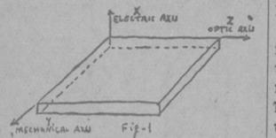
En estas condiciones se ha encontrado que a resonancia se produce cuando la frecuencia es igual a 2,86 + 10 elevado a 6 dividido por el espesor de la placa en milímetros.
