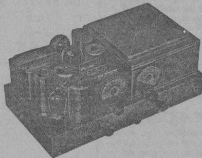
Receptor modelo K Y. Doble onda.—Superheterodino de 10 válvulas (4-235, 2-227, 1-247, 1-247, 1-28 ) Un solo mando de sintonía para cada onda: normal o extra-corta.—Control de tono. Toma para reproducción fonográfica.—Amplitud de recepción 15 a 550 mts.
