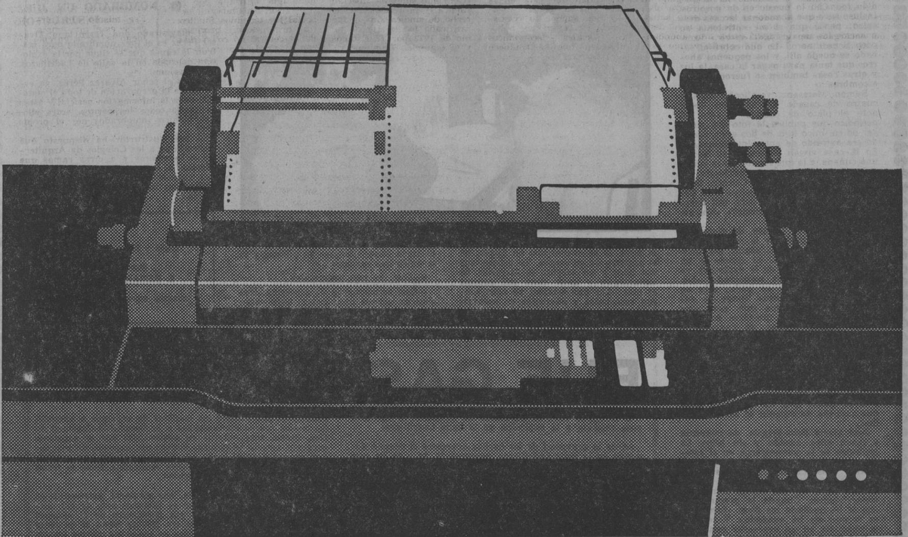
**Auditronic 730:** Sistema contable electrónico. Programa grabado en cinta magnética contenida en cartucho intercambiable. Posibilidad de llevar simultáneamente hasta 6 documentos distintos.
