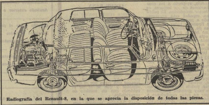
Radiografía del Renault-8, en la que se aprecia la disposición de todas las piezas.
