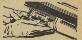
1 TRANSMOVIL 3 se introduce deslizándose en su soporte, el contacto se establece automáticamente, para tomar la alimentación directamente de la batería del coche.
