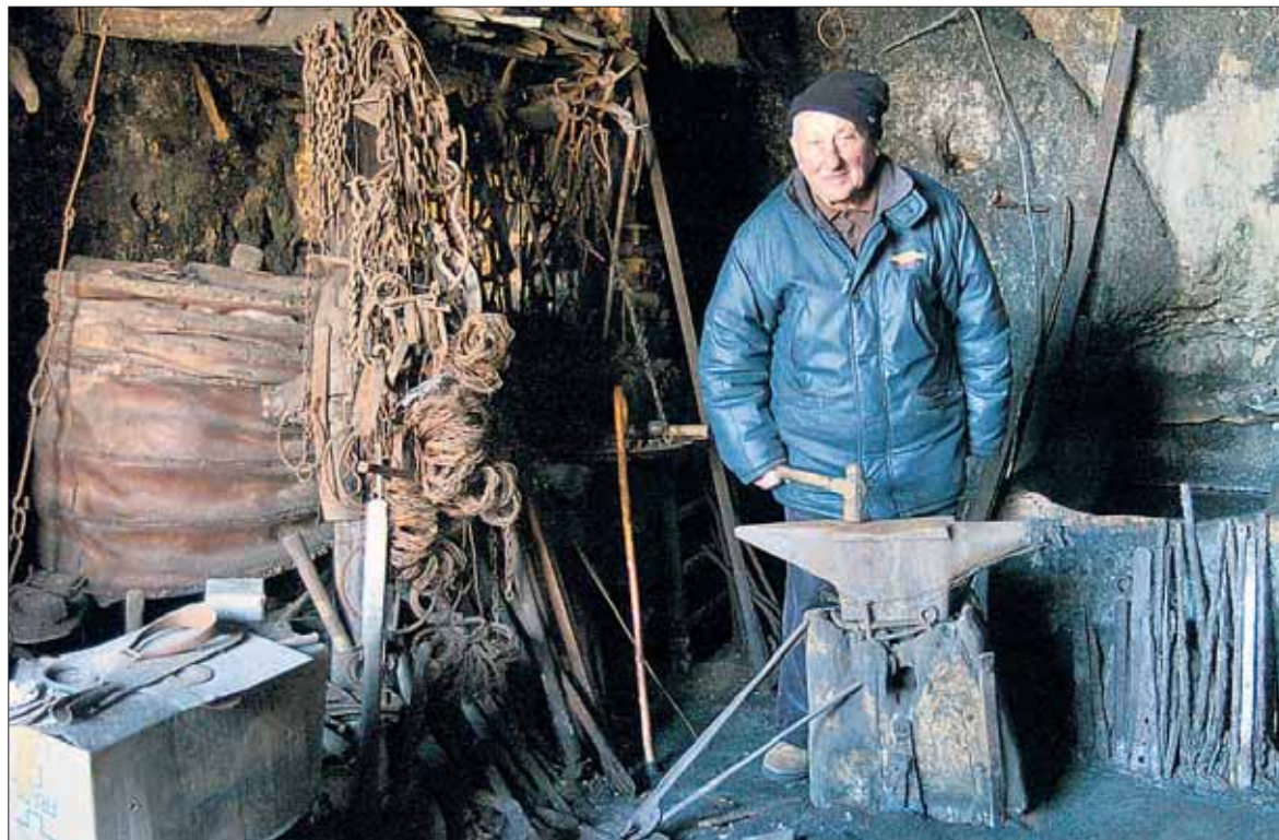
“El Herrerillo”, en su fragua, en la que se aprecian sus principales elementos: el fuelle, el yunque, la pila... / GUILLERMO HERRERO
