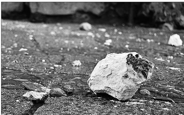
Una de las piedras de caliza que se desprendieron de la cornisa/KAMARERO
