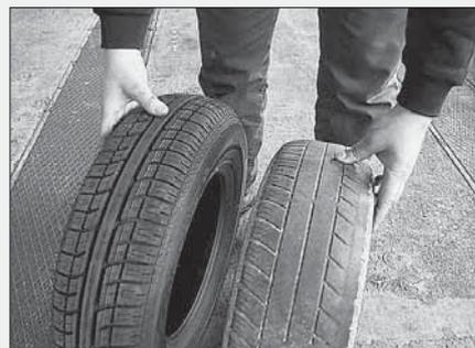
• **Sujeción en la carretera.** El desgaste de las ruedas puede generar serios peligros ya que impide que el agua sea evacuado a través de los canales que deben ser cambiado si son inferiores a dos milímetros.
