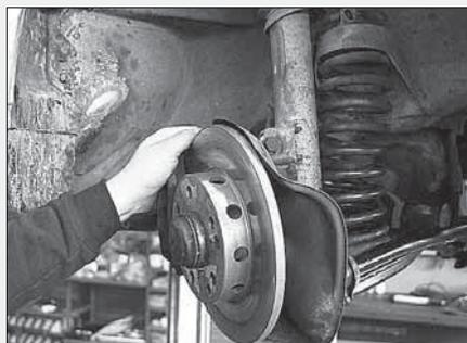
• **Susto o accidente.** Cualquier defecto en sus elementos pueden derivar en que se alargue la frenada. Es necesario vigilar el nivel del líquido, el estado de las pastillas, discos y tambores.
