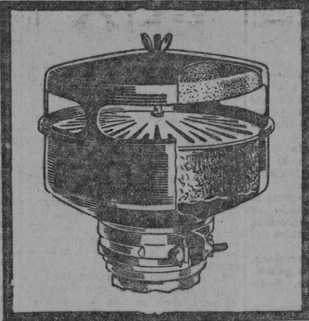
El purificador de aire evita la entrada de polvo y otras materias extrañas que impiden el buen funcionamiento del motor y causan extraordinario desgaste.
