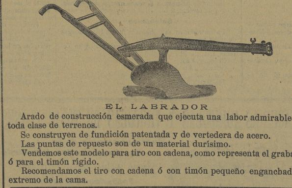
Arado de construcción esmerada que ejecuta una labor admirable en toda clase de terrenos. Se construyen de fundición patentada y de vertedera de acero. Las puntas de repuesto son de un material durísimo. Vendemos este modelo para tiro con cadena, como representa el grabado, ó para el timón rígido. Recomendamos el tiro con cadena ó con timón pequeño enganchado al extremo de la cama.
