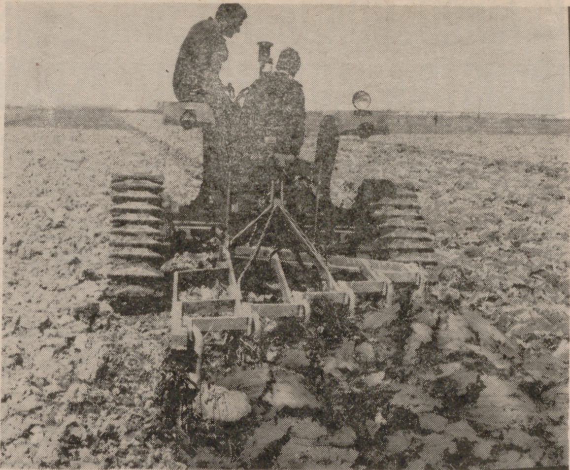
Tractor MOTRANSA 851 trabajando en las Marismas de Sevilla, equipado con equipo trasero de cadenas (Semi-oruga).
