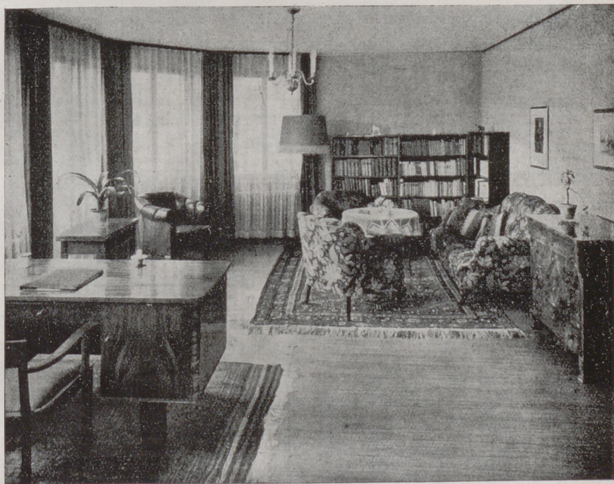
Pavimento de Linóleum Jaspe 2,2 mm, colocado por la casa José Otero.
