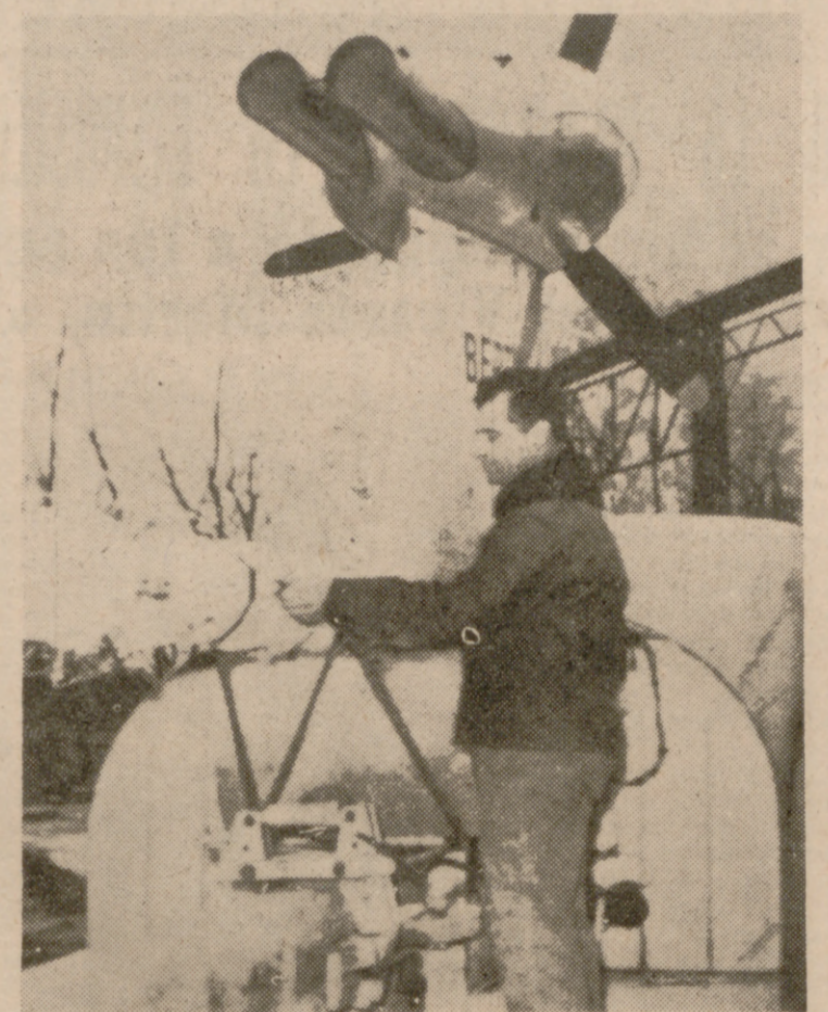
PARIS.—Un técnico realiza los últimos preparativos en el sistema de turbina momentos antes del comienzo de la prueba de ensayo del "Aerotren". Este sistema de transporte, capaz para ochenta pasajeros, se desliza por una monorraíl de cemento y alcanza una velocidad de 300 kilómetros por hora.—(Telefoto Upi-Cifra.)
