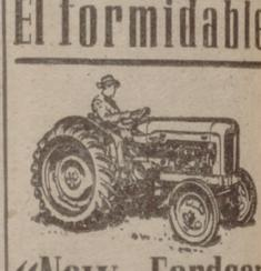
"New Fordson Major Diesel" Ultimo modelo, motor 30 H.P. a la barra y 35/40 a la polea, con nuevo elevador hidráulico toma de fuerza fuerza trilla de dos velocidades con embrague, faros carretera y población, sellos velocidades adelante y dos atrás, consumo con remolque un litro; arando y roturando de tres a cuatro litros gas-oil, y muchos más detalles sobresalientes en arados, roto y otros, cultivadores originales.
