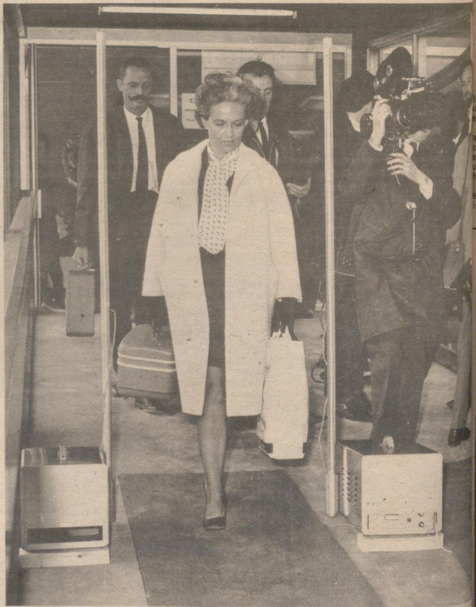
LONDRES.— Un novísimo sistema contra "secuestros" de aviones, ha sido mostrado por la TWA en el aeropuerto de Heathrow. Se trata de un "mecanismo" que se usa en puntos no revelados de las pistas que siguen los aviones de la empresa. Mediante este sistema se puede "captar" la presencia de metales, por tanto, armas, que pueden portar los pasajeros. El dispositivo consiste en un "metro" con un tubo de aluminio que registran la cantidad de metal portado por cada viajero en sus maletas.
