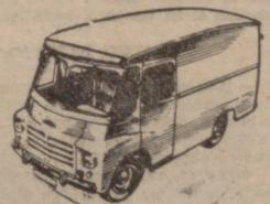
MODELO: LDO-5. Motor 2.178 cm³ de cilindrada y 56 C.V. de potencia. Caja de cambios de 4 velocidades...
