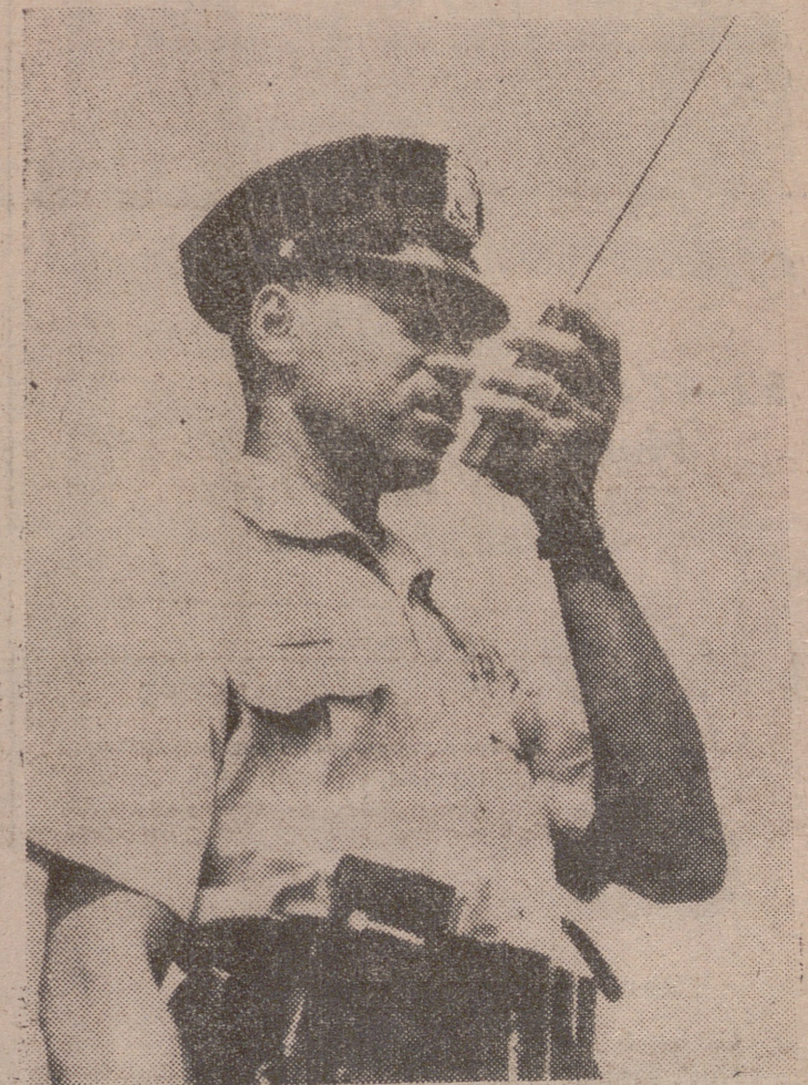
Un patrullero de la Policía metropolitana del Departamento de Washington usa un radioteléfono portátil para mantener contacto con su cuartel general mientras está de servicio en la calle. El receptor está alojado en la funda de cuero que lleva colgada en la parte derecha de su cinturón. —(Foto "AP").
