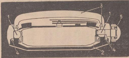
1.- JUNTA ELASTICA. 3.- CRISTAL ARMADO.
