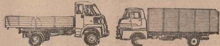
77 HP. 4,5 TONELADAS carga útil MOTOR 107 HP. 6 TONELADAS carga útil
