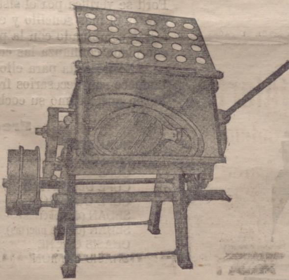
Esta Casa en su deseo de modernizar todas sus máquinas, presenta hoy nuevo modelo de ADOBADORA para harinas, con helices dobles y movimiento reversible, con lo que se logra el trabajo más perfecto y la envuelta y mezcla completa de los elementos de fabricación.
