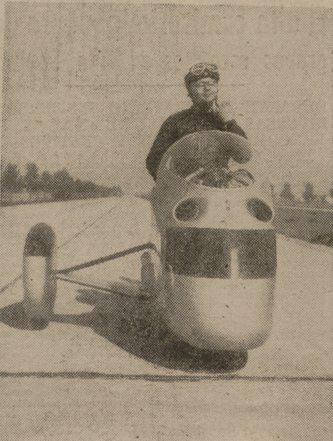
Wilhelm Noll, sobre su máquina "BMW", de 500 c. c., en la que consiguió los nuevos records de la milla y el kilómetro lanzados, a 285 y 282 kilómetros-horas, respectivamente. (Foto Cifra.)
