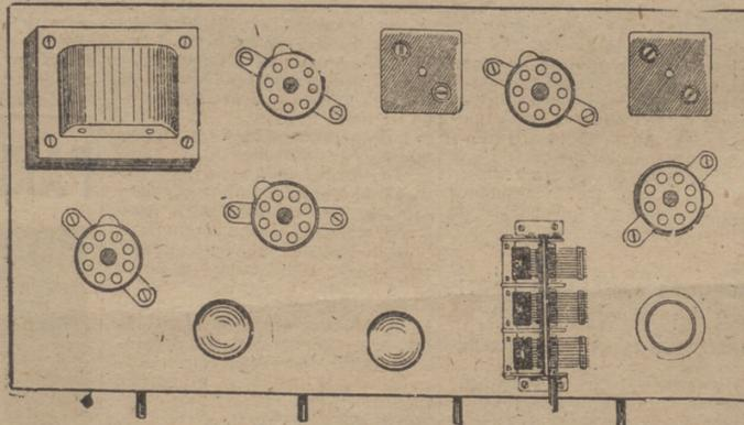
Fig. 141.—Distribución de elementos sobre el chasis
