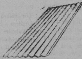
Bovedillas patentadas para la construcción de techos.
