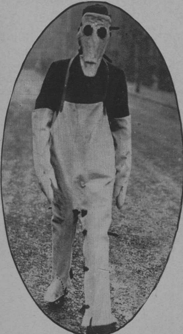
Un traje que permitirá, en caso de accidentes en las minas, permanecer bajo tierra largo rato, para coadyuvar en los trabajos de salvamento. — (Fot. Keystone)
