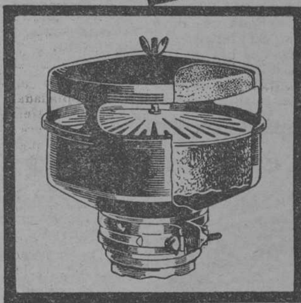
El purificador de aire evita la entrada de polvo y otras materias extrañas que impiden el buen funcionamiento del motor.
