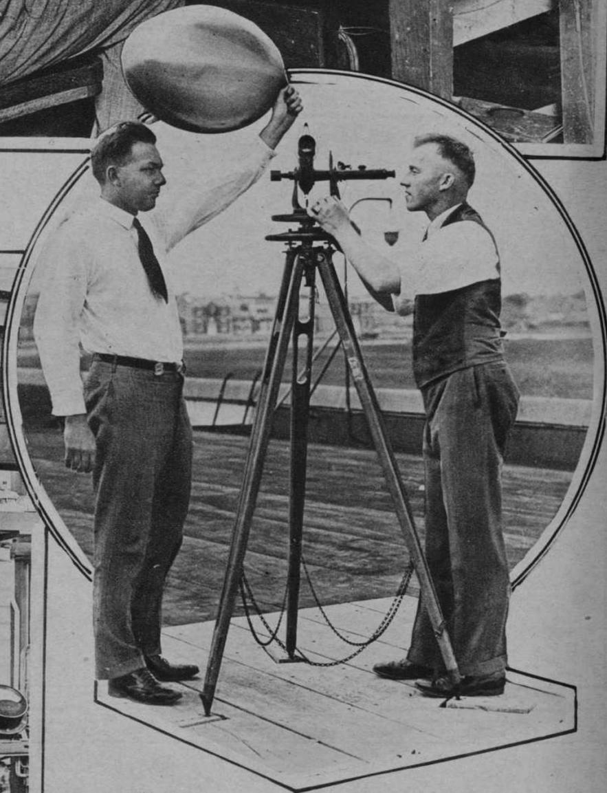
Lanzamiento de un globo-sonda, para radiar las observaciones meteorológicas interesantes a los aviadores
