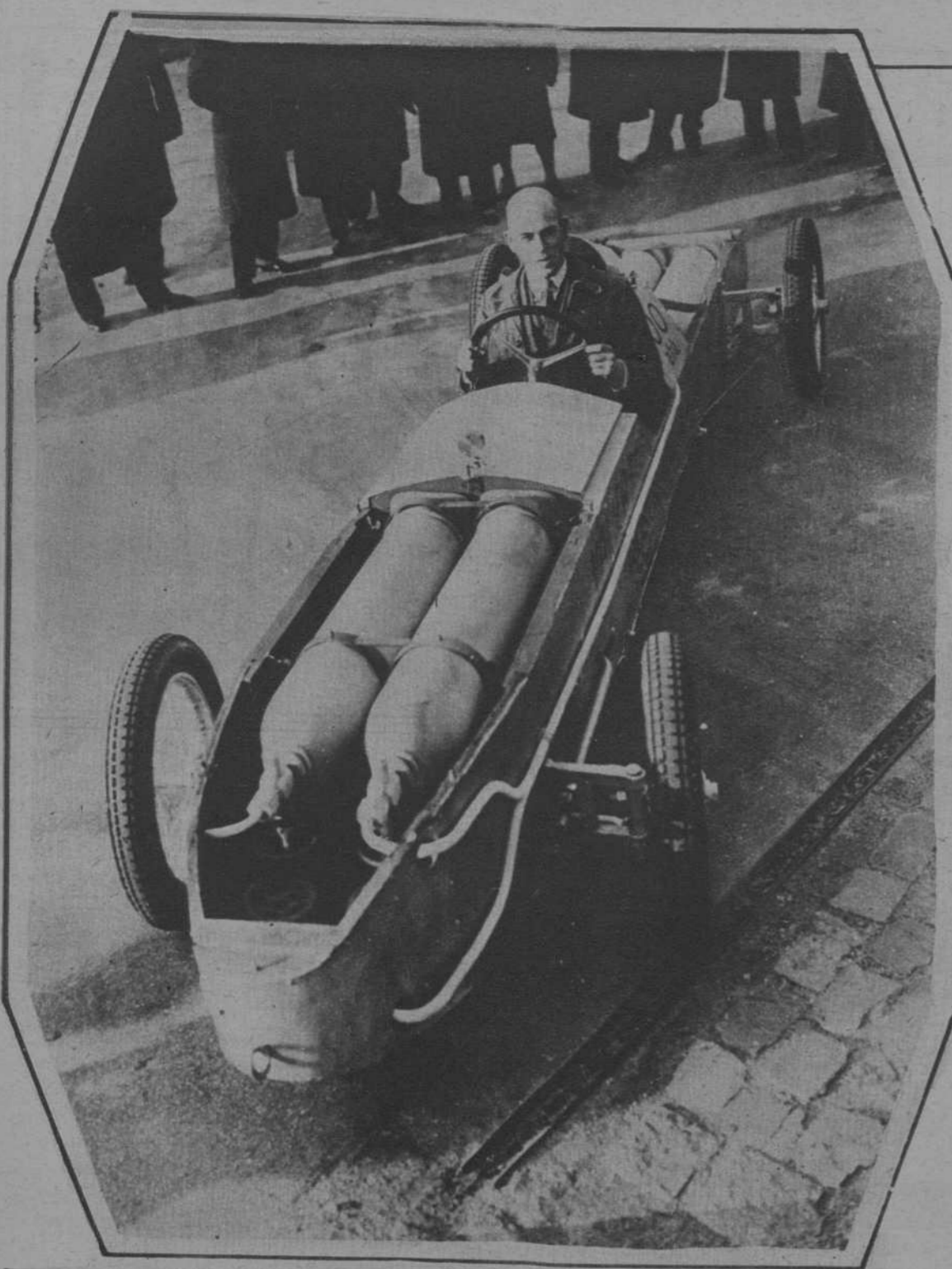
El ingeniero alemán Max Valier acaba de inventar un auto-cohete movido por amoníaco, con el que pretende batir todos los records precedentes de velocidad terrestre. Con dicho vehículo — que, en reposo y en marcha muestran las fotografías — ha realizado, con éxito, interesantes pruebas en la pista "Avus", de la capital alemana. (Fots. Keystone)
