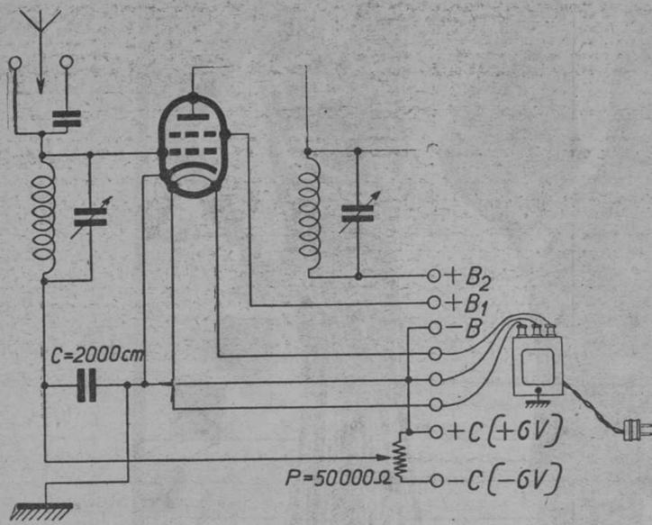
Figura 2.—Conexión de un potenciómetro por medio de una pila seca, lo que permite regular la selectividad y la potencia.
