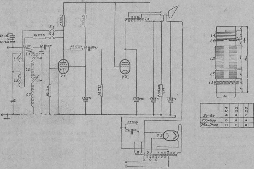
Esquema del receptor Tunsgam, de tres válvulas, corriente alterna y ondas extra-corta, normal y larga.
