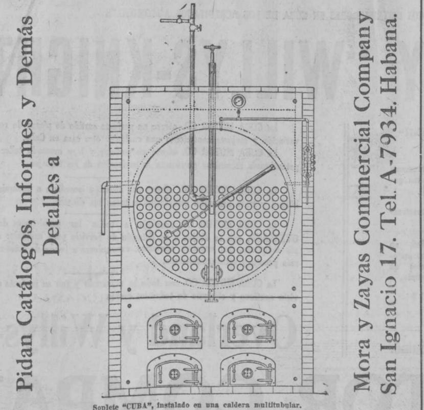
Soplete "CUBA", instalado en una caldera multitubular.
