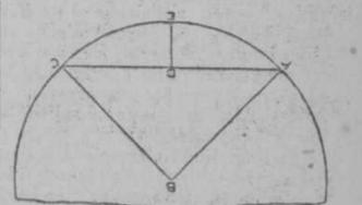
requerido y se coloca el ángulo de una escuadra en el centro del círculo para trazar las líneas AB, BC y AC. Se traza también la línea DE partiendo del centro de la línea AC en ángulos rectos a la periferia del círculo. Tres veces el diámetro del círculo sumadas a la longitud de la línea DE dan la circunferencia buscada, con toda exactitud que puede desearse para aplicaciones prácticas.
