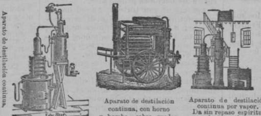
Aparato de destilación continua, con hornos y bomba, sobre ruedas.
